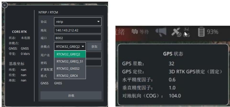
还可以打开**扩展配置**开关进行个性化设置（比如连接超时、读取超时、NMEA 超时等）；可选择“使用无人机的 home 点”或者“当前运行地面站设备 GPS 位置”作为 NMEA 的传输位置（注：位置获取仅在点击连接时，不会实时跟随改变）。
