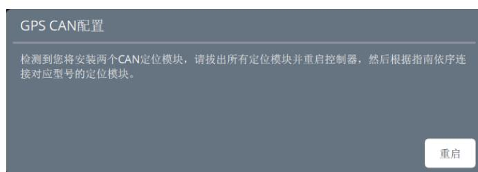
请先确保定位模块没有连接到智能控制器，如果已经连接请立刻拔出。拔出后，点击“重启”按钮。然后等待智能控制器重新启动。
