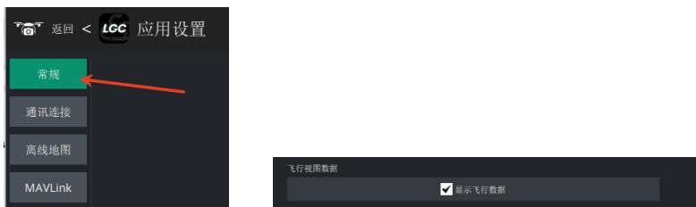
即可在飞行视图中飞机图标旁边看到飞行高度、速度、电量等信息。当地面站同时连接并操作多台无人机时，亦可同时关注每台飞机的数据。如下图。
