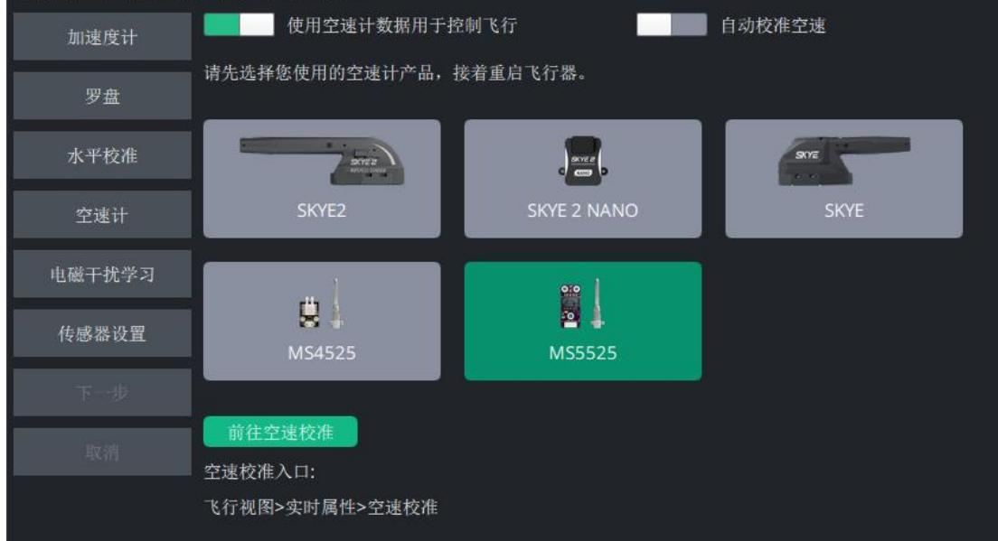
(3) 根据实际情况，配置“使用空速计数据用于控制飞行”和“自动校准空速”。
