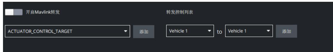
(2)左侧点击下拉框选择对应的消息，并点击“添加”（可添加多个转发消息）。
