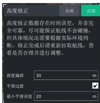
**高度偏移**为在已知的高度数据往上再偏移多少，用于防止高度过于贴近导致问题；
